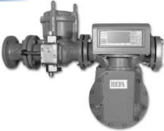
Rotační průtočná objemová měřidla se používají k měření proteklých objemových množství kapalných paliv a olejů bez mechanických nečistot. Jsou určena pouze pro jednosměrný průtok. Zařízení předvolby umožňuje zvolit předem velikost dodávky média, její výdej a dvoustupňové ukončení výdeje. Kromě vlastního měřidla je nutné použít v měřicím okruhu další zařízení, a to filtr mechanických nečistot, odlučovač plynů a par (nepoužívá se pro oleje), zpětný ventil a kontrolní hledítko.
