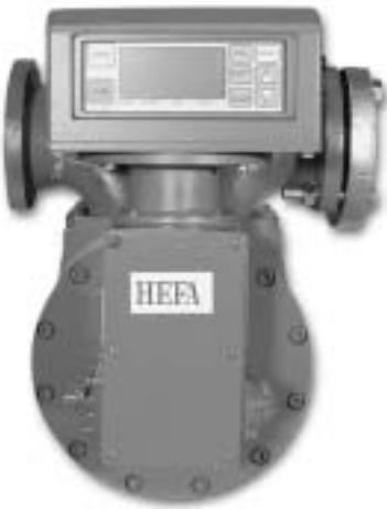
Rotační průtočná objemová měřidla se používají k měření proteklých objemových množství kapalných paliv a olejů bez mechanických nečistot. Jsou určena pouze pro jednosměrný průtok. Kromě vlastního měřidla je nutné použít v měřicím okruhu dalších zařízení sestávajících z filtru mech. nečistot, odlučovače plynů a par, (nepoužívá se pro oleje) zpětného ventilu a kontrolního hledítka.
