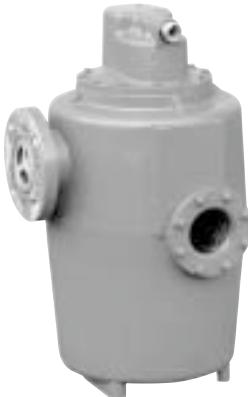
Odlučovač s filtrem je kompaktní zařízení, které spojuje funkce odlučovače a filtru. Montuje se do technologických celků čerpacích, stáčecích zařízení apod. Slouží k odlučování vzduchu nebo plynů nahromaděných v přívodním potrubí měřiče, současně se používá k filtrace tekutých paliv – nafty, benzínů, apod.
