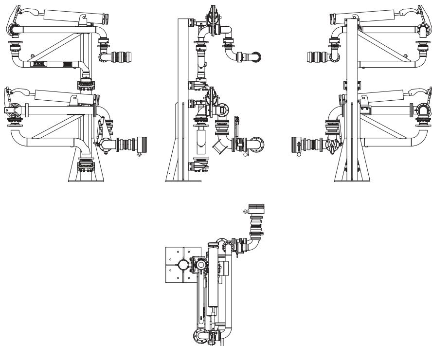
Instalace dvou rámenn rozdílného provedení na společném sloupu slouží k vyprazdňování nebo plnění autocisteren nebo železničních cisteren. Menší z dvojice rámenn DN 50 (2") nebo DN 80 (3") se využívá k vrácení par ze systému do cisterny (v případě vyprazdňování cisterny). Větší z dvojice rámenn DN 80 (3") nebo DN 100 (4") se používá ke stáčení produktu z cisterny nebo k jejímu plnění. Řešení umožňuje komfortní obsluhu cisteren s nízkými nároky na zastavěný prostor na stáčecím místě.
