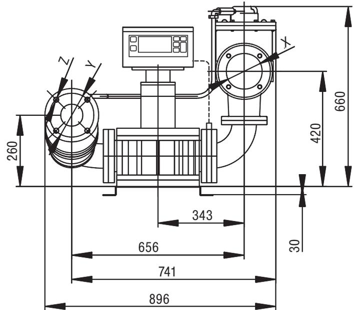
Připojovací rozměry / Connecting dimensions / Присоединительные размеры
