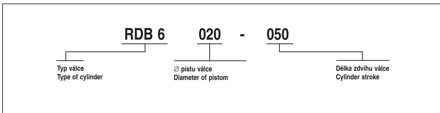
**Pneumatické válce s blokovacím zařízením Ø 20 až 25**
